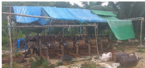
Gambar 4. Alat Gelondong Proses Pengolahan Emas Menggunakan Merkuri
