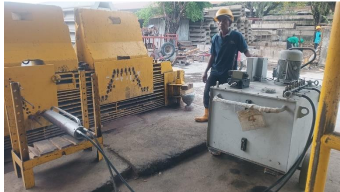
Gambar 3. 7 Proses penarikan dengan jack stressing
