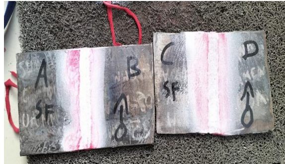
Gambar 2: Hasil Uji spesimen pengelasan dengan variasi arus 60,110 Ampere.
