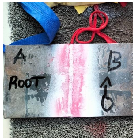
Gambar 5: Cacat las Undercut. (1), Underfill(2),pada Spesiment 1
