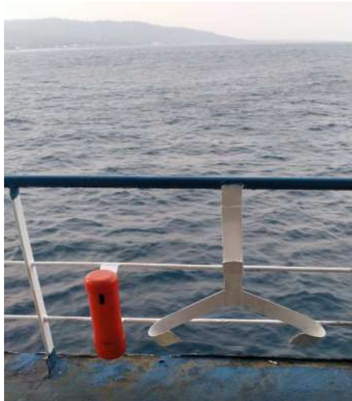
Gambar 4. 1 Salah satu Lifebouy tidak terpasang diatas kapal Sumber: Dokumentasi Peneliti
