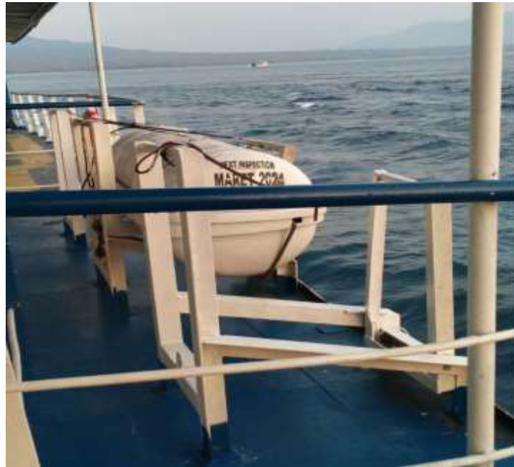
Gambar 4. 3 Satu Liferaft tidak terpasang diatas kapal Sumber: Dokumentasi Peneliti
