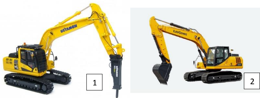
Gambar 6. Peralatan yang Dipakai untuk Pekerjaan Pembongkaran Pondasi dan Saluran Beton Bertulang (Sumber : Google Image)
