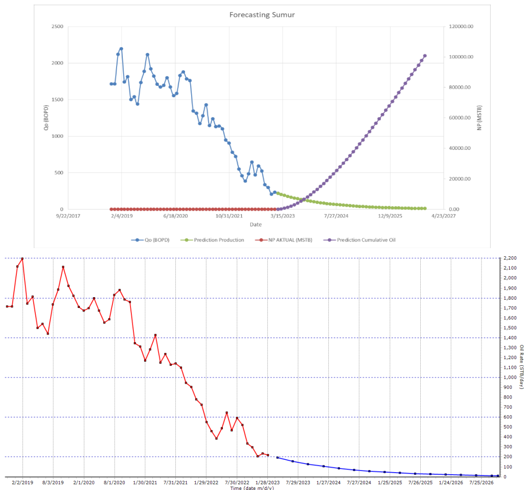
Gambar 4. 1 Grafik Analisa DCA pada Excel dan Software IPM-MBAL
