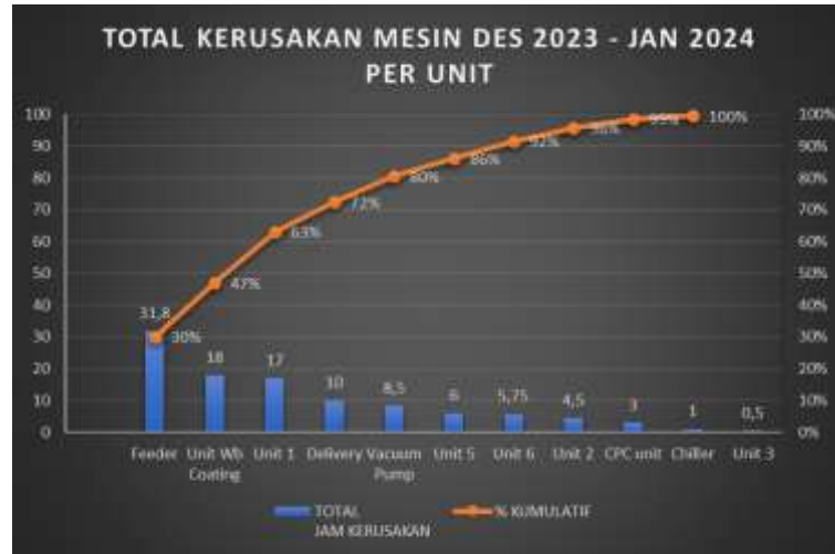
Gambar 3.6 Grafik Analisis Kerusakan Per Komponen Mesin SMCD 6 Dengan Pareto
