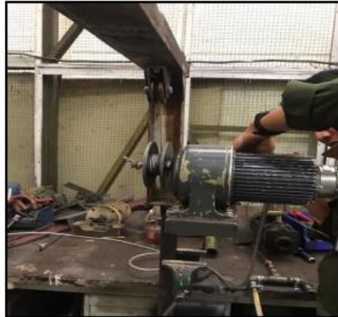
Gambar 9. Pemasangan Power Motor
